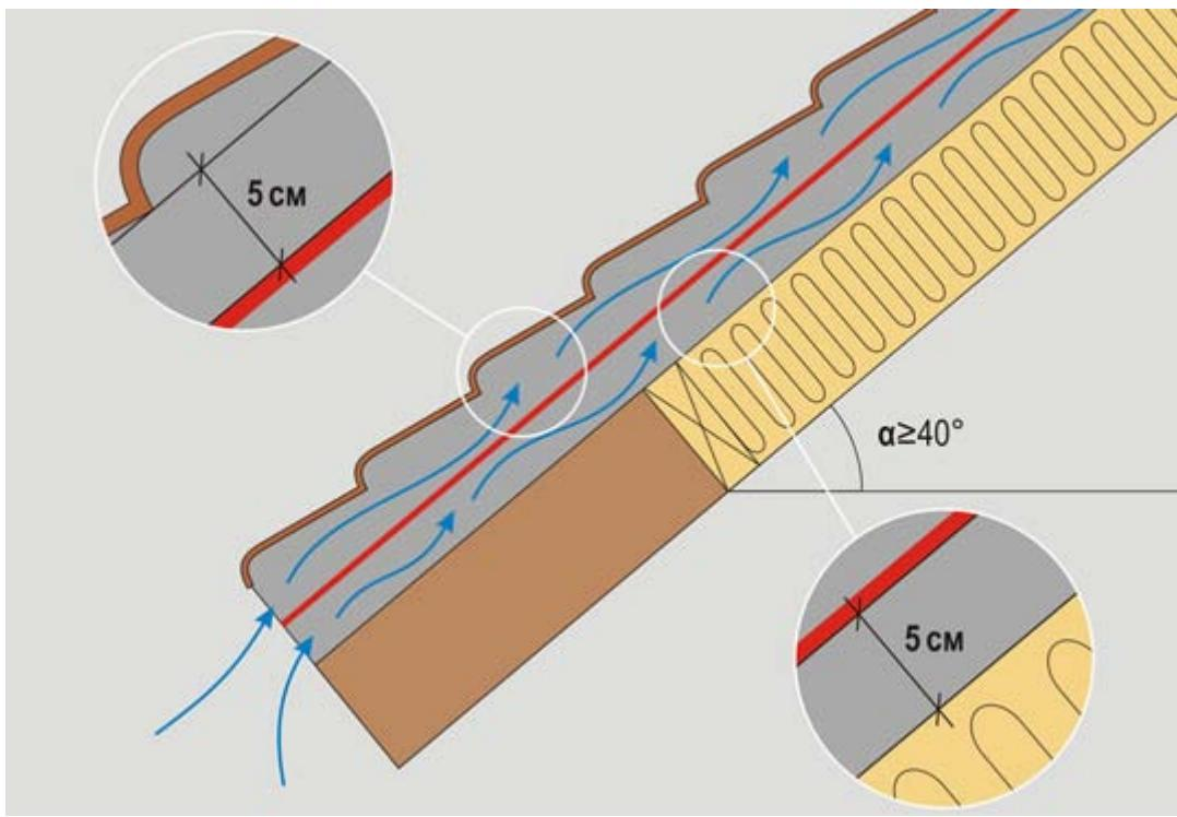
**ВАЖНО:** Ондусис А 100 монтируется любой стороной к утеплителю.**ВАЖНО:** На скатных крышах утепленных мансард Ондусис А100 монтируется с двойным вентиляционным зазором между плёнкой и кровлей и между плёнкой и утеплителем минимум 5 см. Угол наклона ската не менее 40°.
